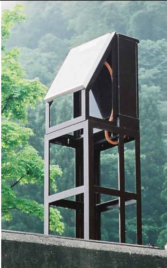
常願寺川の流砂量測定装置
