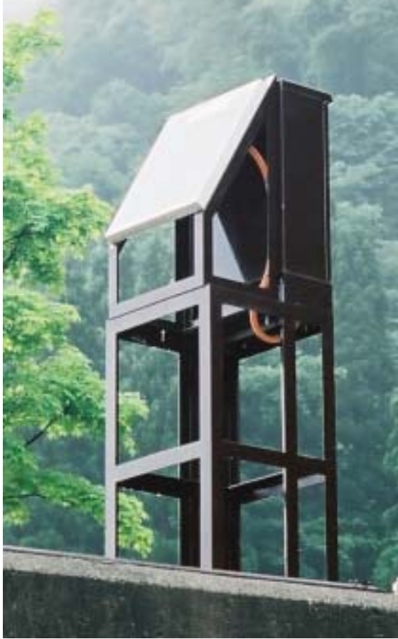
常願寺川の流砂量測定装置
